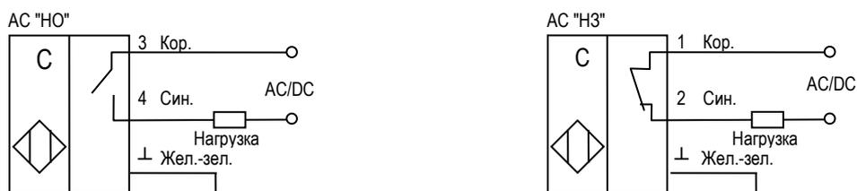
**Рисунок 2 - Схемы подключения датчиков**
